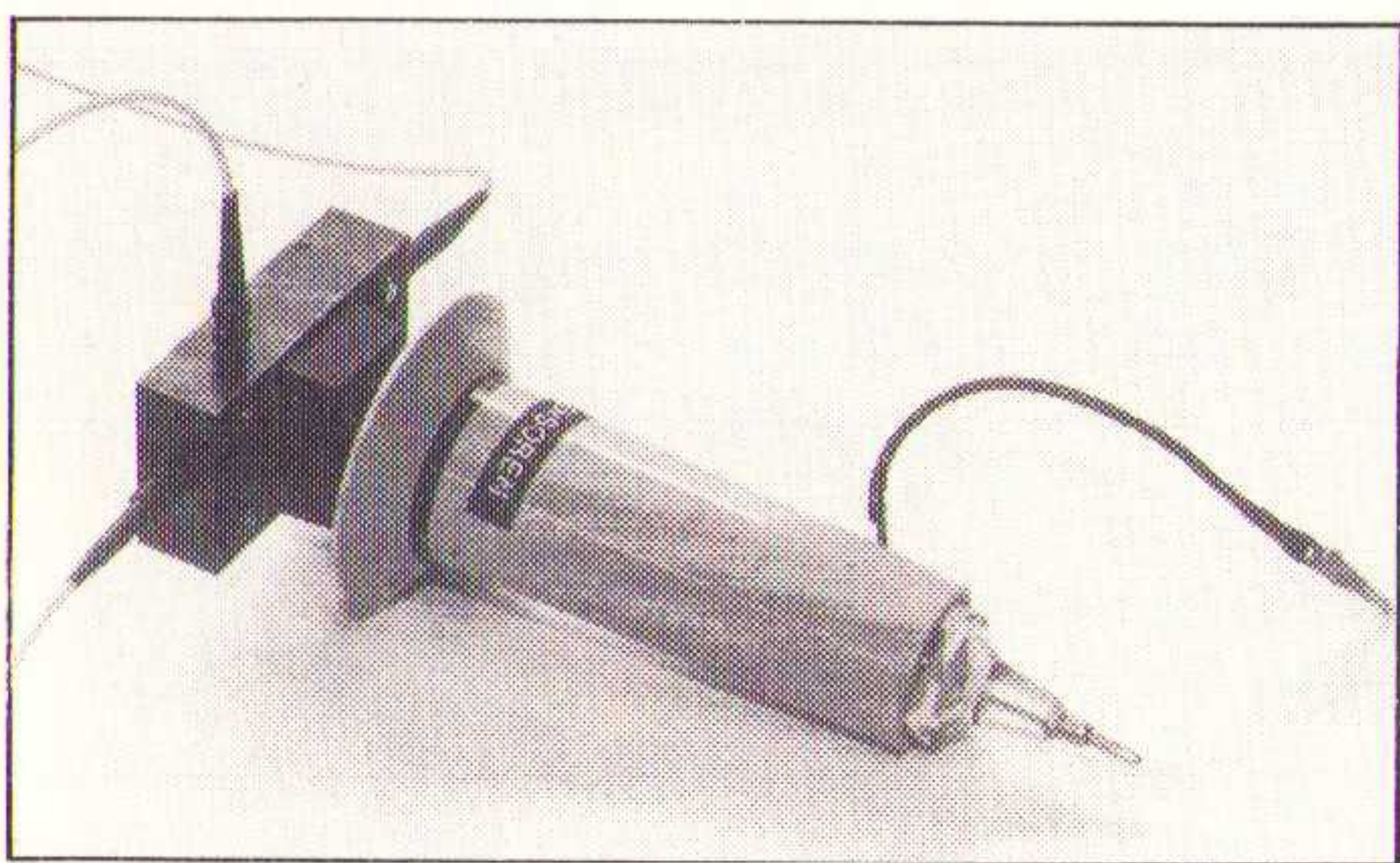
Fig. 7 Optische spanningssensor voorzien van een spanningsdeler. Meetbereik: 100 V ... 30 kV, bandbreedte: 10 Hz ... 1000 kHz.
